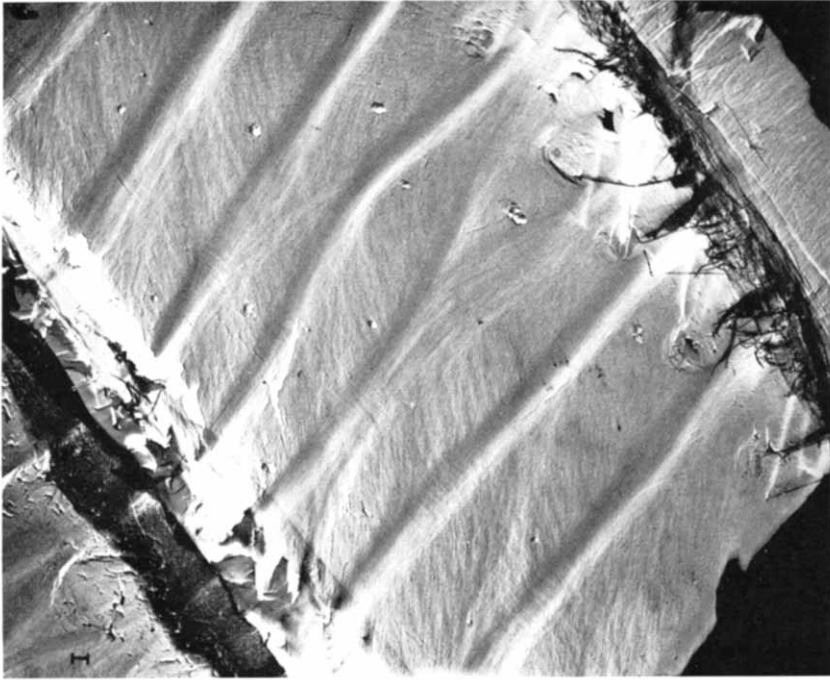
Fig. 3. Zellwand mit spiraligen Versteifungen, Douglasie . el. opt. 1400:1, Abb. 2300:1 (2460/52)
